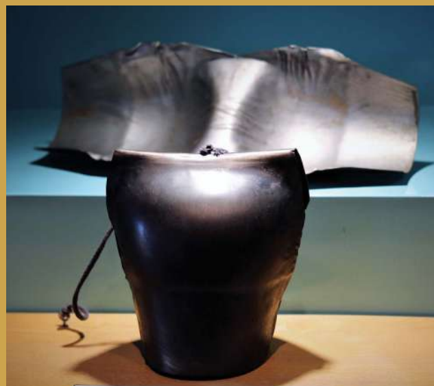
↳ Sonnaïlle de type redon en cours de fabrication. Une fois la tôle mise en forme, il faut encore encuvrer la sonnaïlle (la couvrir d'une fine couche de cuivre) pour la rendre bien sonore. © F. Renerre / Pays HLV
