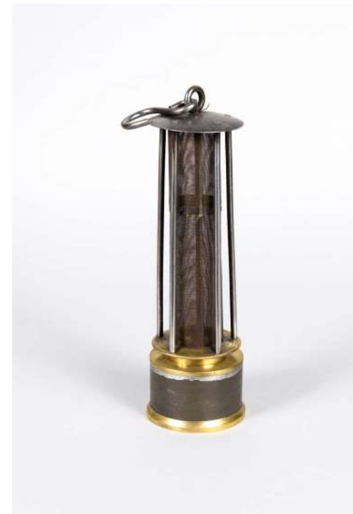
↳ Lampe Davy. La flamme est protégée par un tamis. © C. Cordier / Archives départementales de l'Hérault
