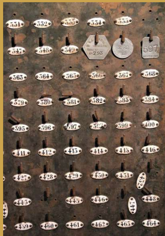
↳ Détail du tableau à jetons. Ce tableau était disposé dans la lampisterie, pièce où étaient gardées et entretenues les lampes. Chaque mineur possédait un jeton marqué d'un numéro correspondant à celui de sa lampe. Ce jeton était accroché au tableau lorsqu'il récupérait sa lampe pour descendre dans la mine. Ainsi, le ou la lampiste savait à tout moment quels mineurs étaient sous terre. © F. Renerre / Pays HLV
