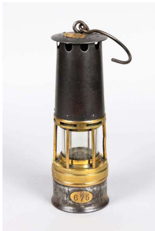
↳ Lampe Marsaut. Le tamis est protégé par une tôle métallique. © C. Cordier / Archives départementales de l'Hérault
