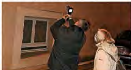
La caméra thermique permet de détecter les pertes de chaleur.
